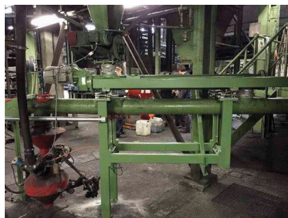
Bild 3: Förderschnecke mit Waage
