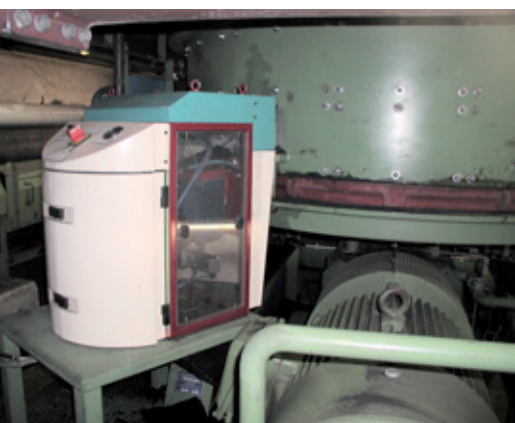
Bild 10. Aufbau des ROTOCONTROL RTC 106 direkt am Mischer
